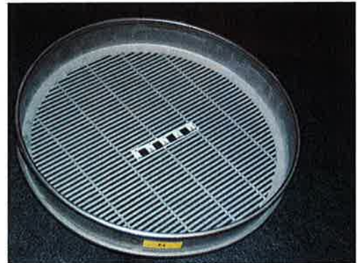
Bild 1-4. Skjutmått för bestämning av LT- Index (3) resp. (5) samt 2 olika fabrikat av spaltsiktar för flisighetsindex för grovballast samt "Dansk Box".
