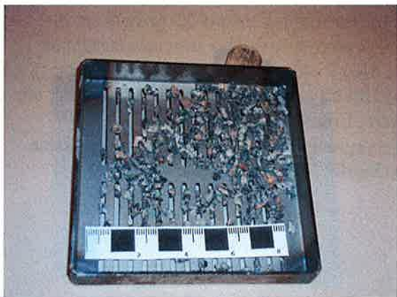
Bild 7 och 8. Material D 3,15–4 mm som stannar på spaltsikt 2 mm till vänster och som passerar sikt 2 mm till höger.
