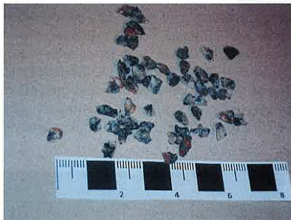
Bild 7 och 8. Material D 3,15–4 mm som stannar på spaltsikt 2 mm till vänster och som passerar sikt 2 mm till höger.
