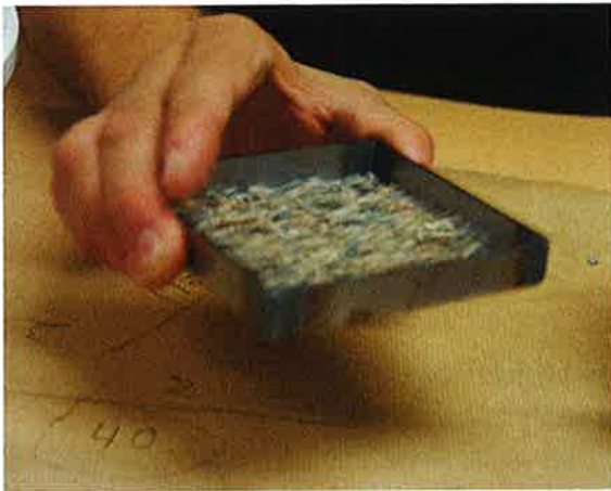
Bild 9. Manuell siktning med spaltsikt.
